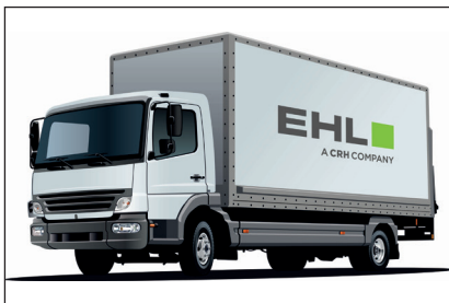
7,5 Tonnen LKW mit Ladefläche und Plane; Entladung erfolgt per Hubwagen
