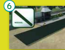
6 Colocar malla para el control de las malas hierbas
